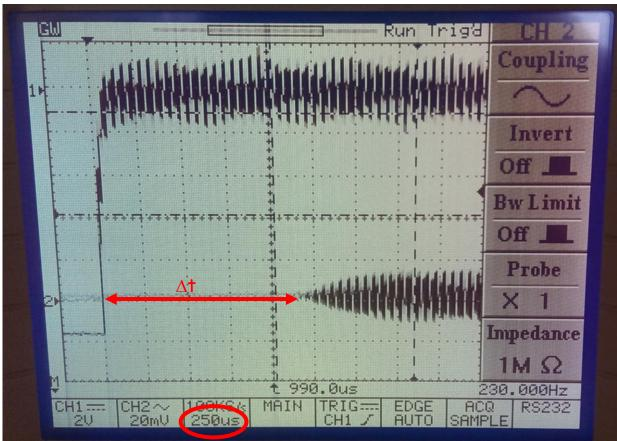
Montage pour illustrer le principe de l'échographie : mesure de la distance à un objet
